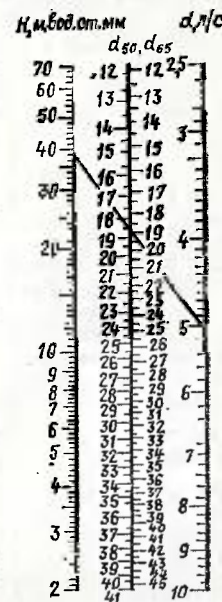
Рис. 25. Номограмма для подбора диафрагм, установленных у пожарных кранов.
